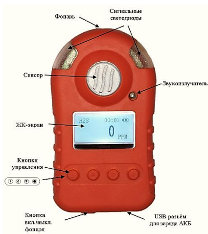
Рисунок 1.2 – Внешний вид газоанализатора с указанием элементов
