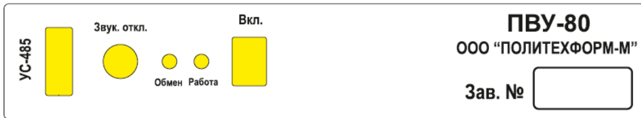
Рис. 2. Общий вид шильдика задней панели пульта
