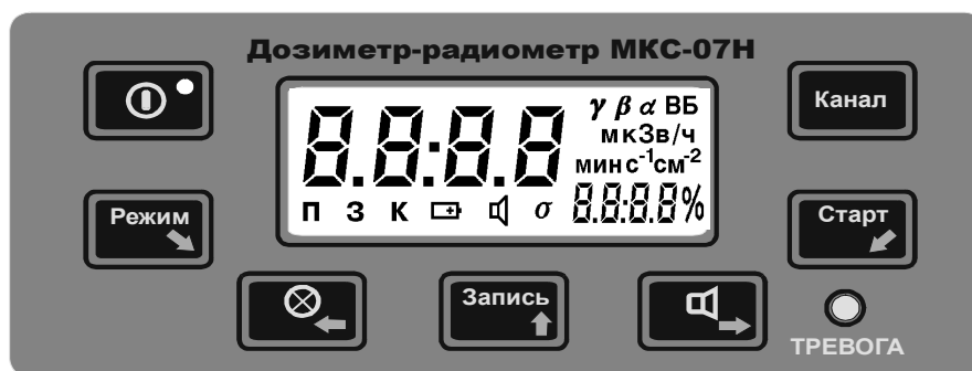
Рис. 1.4.2. Внешний вид лицевой панели пульта дозиметра.
